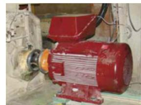
Les **moteurs électriques synchrones** à aimants permanents confirment leur montée en puissance et concurrence désormais certaines applications hydrauliques à faible rendement.
